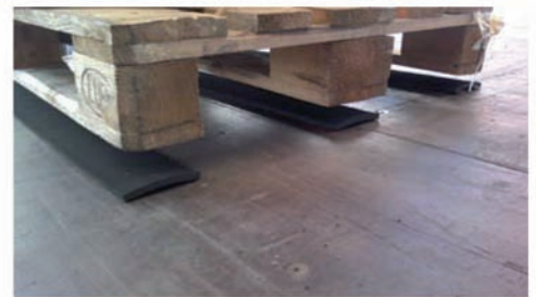
Bild 1: Palette mit Ladung auf 3 Stück RhM Streifen PIKKI strong vollflächig unter den Kufen längs zur Zugrichtung
